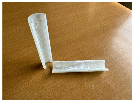
図8 3Dプリンターで作成した型
